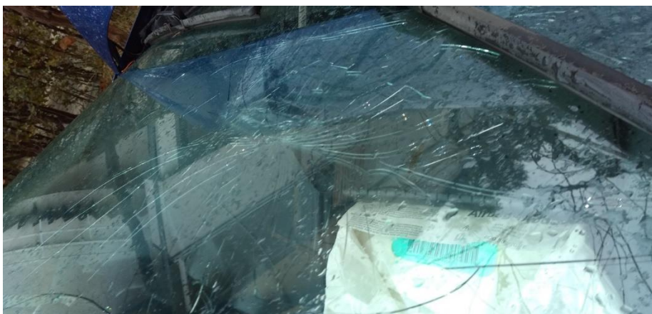
Сл.6: Оштетувања на предно ветробранско стакло од ПМВ марка „Seat Ibiza 1.4TDI”
