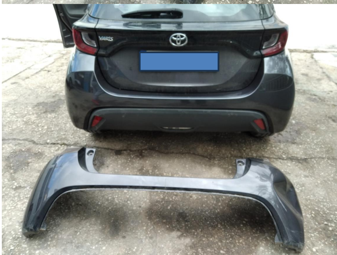
Слика 1а и б): Оштетен заден браник – горен дел и заменет браник монтиран на ПМВ марка „Toyota Yaris” со рег.број РР-XXXX-YYY
